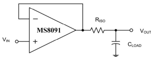
图 1. 串联电阻与负载电容
