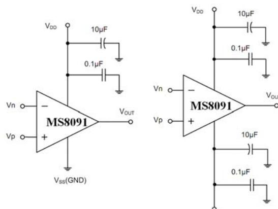
图 2. 带旁路电容的放大器
