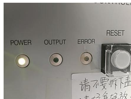
刚开机预热，不影响使用，约五分钟后Output灯自动变成常亮，此时调制精度最高。
