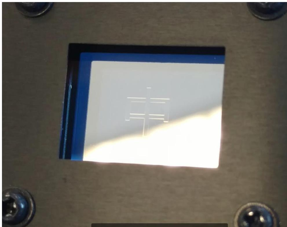
转动SLM到一个合适的观察角度，可以观察到液晶的排列显示出一个“中”字。
